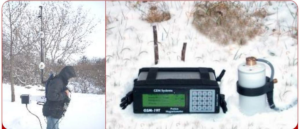
O GSM-19TGW de precessão de Protón vem configurado com uma mochila para transporte, console, sensor adicional para leituras (simultâneas) do gradiômetro, GPS integrado e sistema de VLF EM
